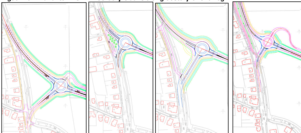
Figuur 10.4: varianten 1 t/m 4 noordelijke aansluiting oostelijke rondweg
