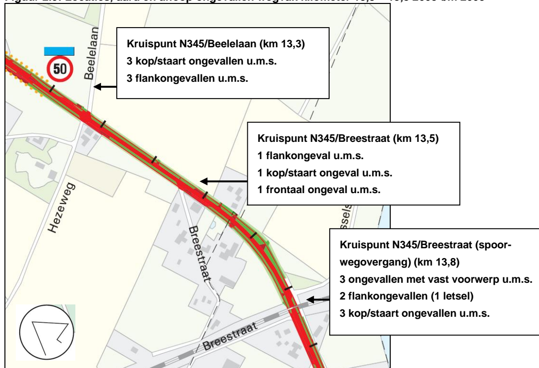
Figuur 2.9: Locaties, aard en afloop ongevallen wegvak kilometer 13,3 – 13,8 2005 t/m 2009
