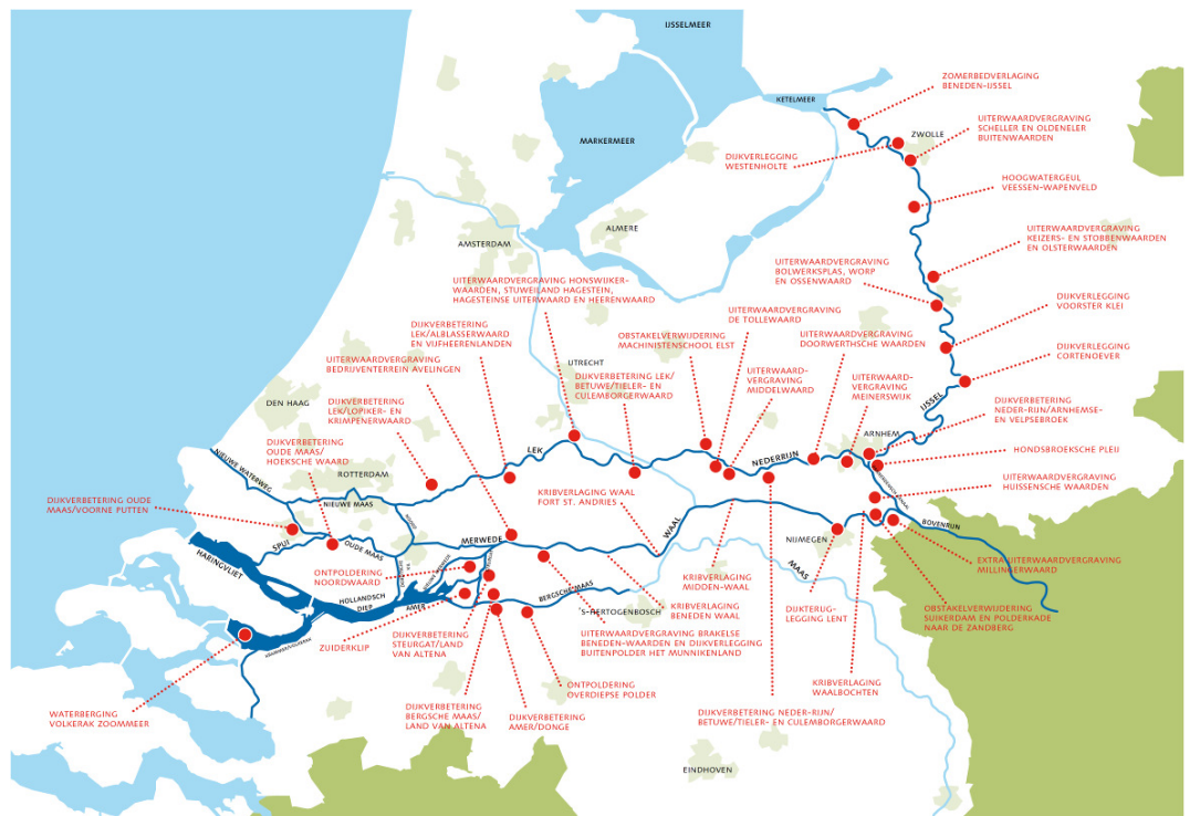
Figuur 2-1 Basispakket maatregelen Ruimte voor de Rivier 2006 (bron; www.ruimtevoorderrivier.nl )
