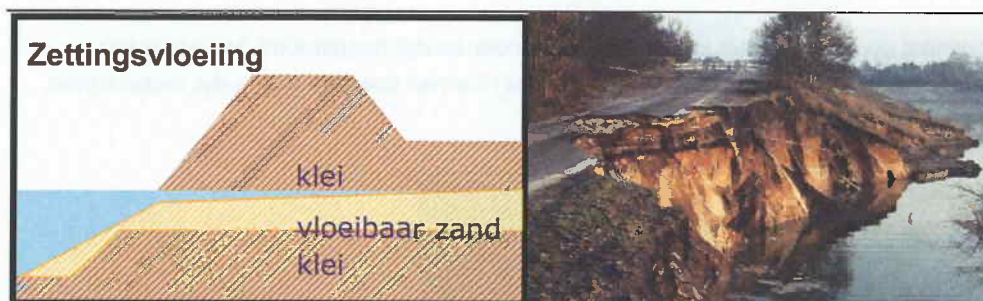
Figuur 2.7 Schematische weergave en foto zettingsvloeiing [bron foto: Optimum, Nr. 9 september 2002]
