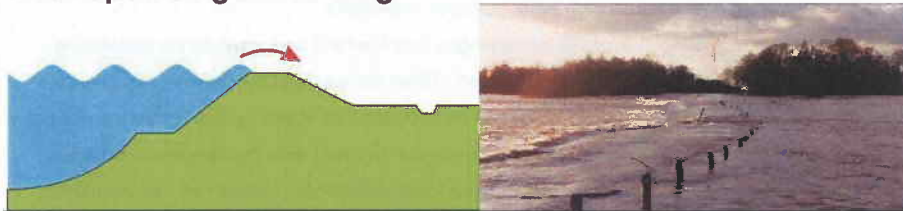
Figuur 2.4 Schematische weergave overlopen en golfoverslag als faalmechanisme [bron: helpdeskwater.nl] en een voorbeeld van een overstromende zomerkade
