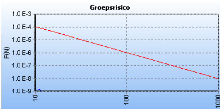
Figuur 30. FN-curve groepsrisico leiding basisschool schuthoek (Stationing 16800-17800)
