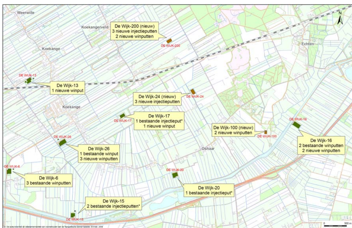
Figuur 4.1 Overzicht locaties en puttenconfiguratie (* winputten worden omgebouwd naar injectieputten)
