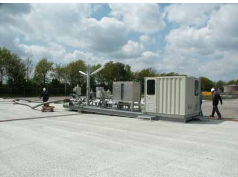
Figuur 9. De verplaatsbare productie skid voor een nieuwe puttenlocatie
