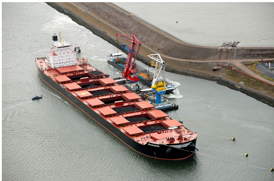
Kolenschip wordt gelichter aan de IJ-palen
