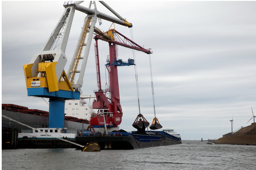
Kolen worden d.m.v. mobiele kranen overgeslagen in een binnenvaartschip
