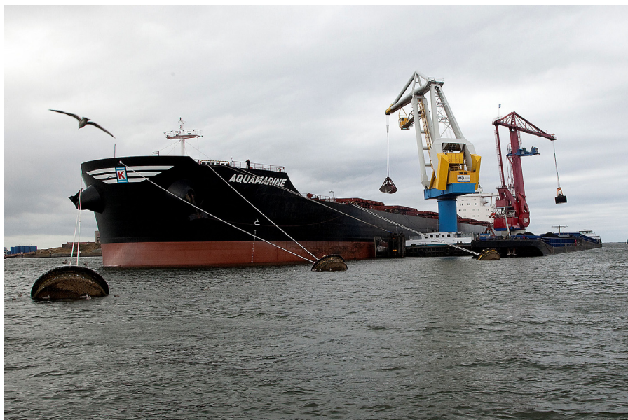
Kolen worden van kolenschip overgeslagen in binnenvaartschip op lichterlocatie
