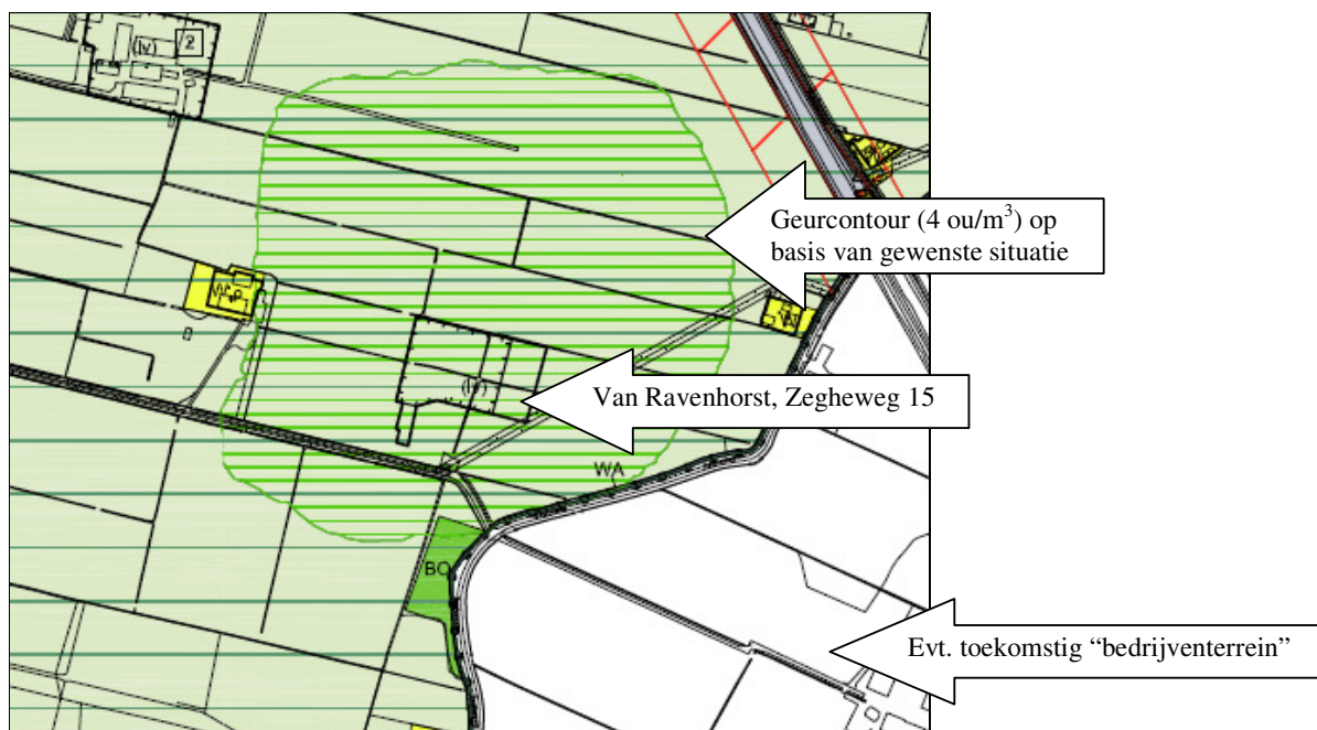
Figuur 5: weergave van de 4 \text{ ou}/\text{m}^3 -geurcontour op basis van de gewenste situatie
