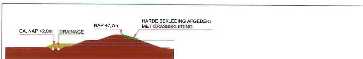
Dempen watergang met aanbrengen drainage, verharding buitentalud met grasbekleding
