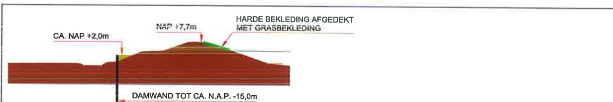
Aanbrengen damwand, verharding buitentalud met grasbekleding
