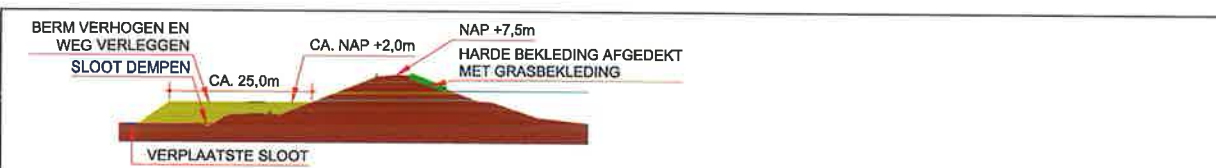
Verhogen berm/weg en verleggen watergang (ca. 25 m), verharding buitentalud met grasbekleding
