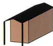
Overstek dak aan korte zijde, aan lange zijde geen overstek
