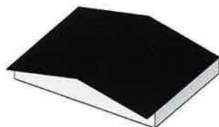
Dakoverstek kopgevel minimaal 3m
