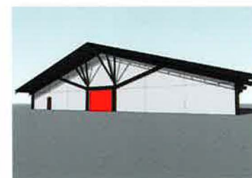
Voorgevels met verbijzonderde spantconstructies
