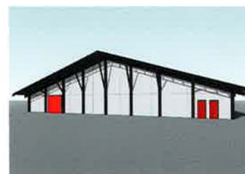
Voorgevels met verbijzonderde spantconstructies
