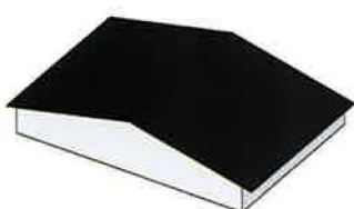
Dakoverstek zijgevel minimaal 1m
