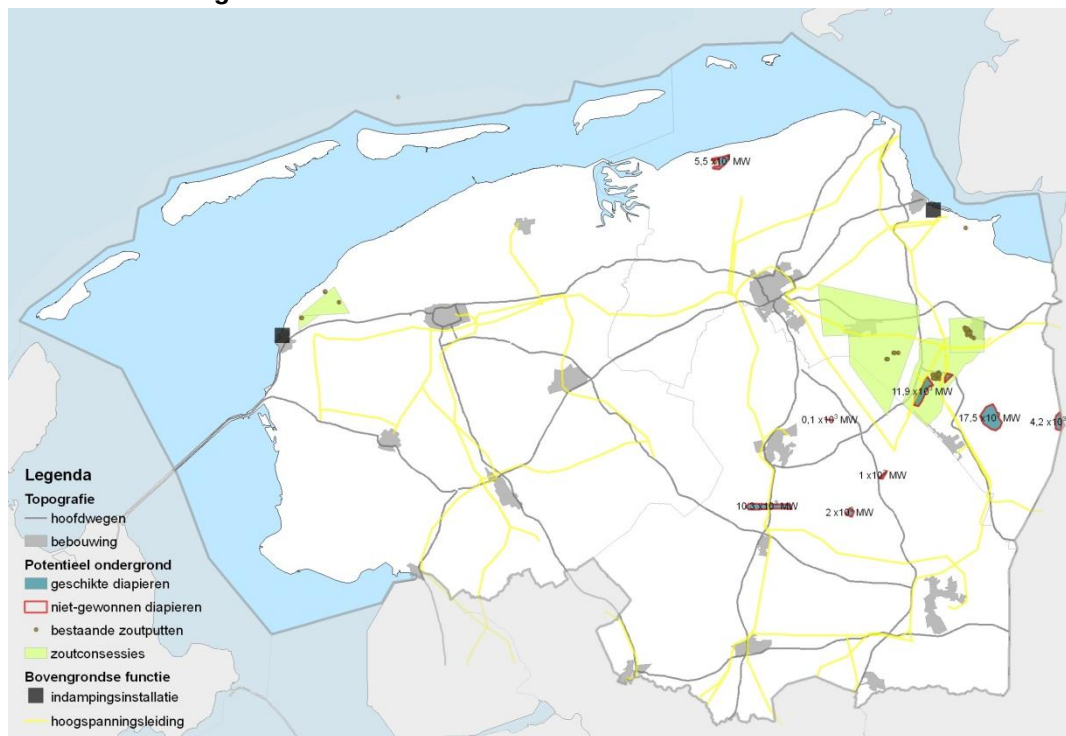
Figuur 2.20 Potentieel persluchtopslag in cavernes
