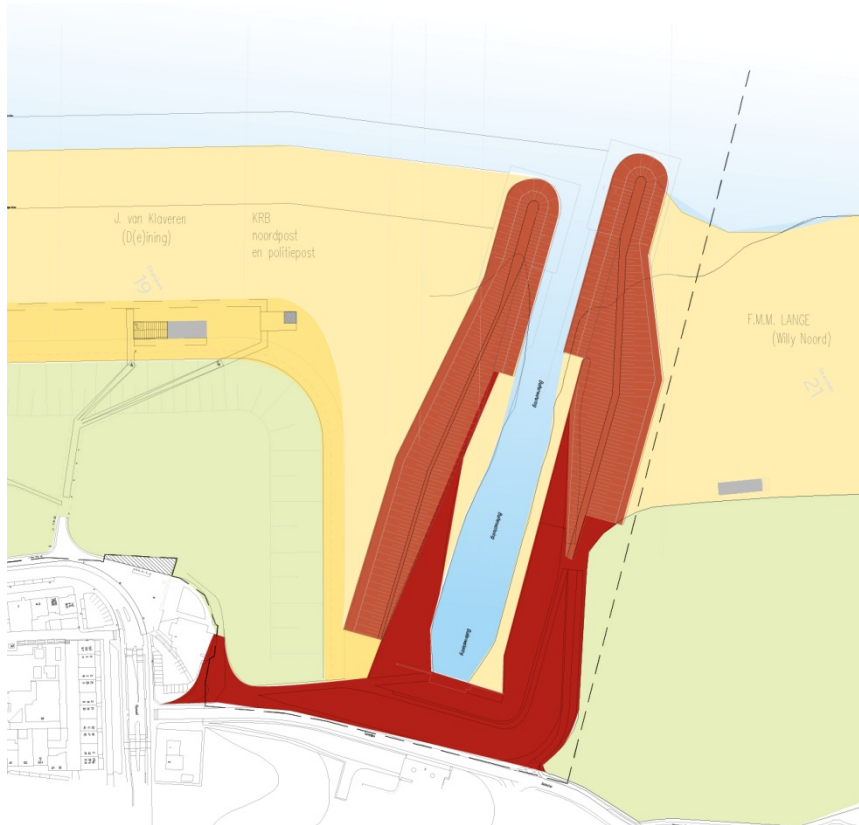
Afbeelding 14 Bovenaanzicht van het verlengde Uitwateringskanaal
