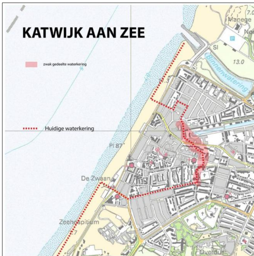
Afbeelding 5 Huidige waterkering en zwakke gedeelte
