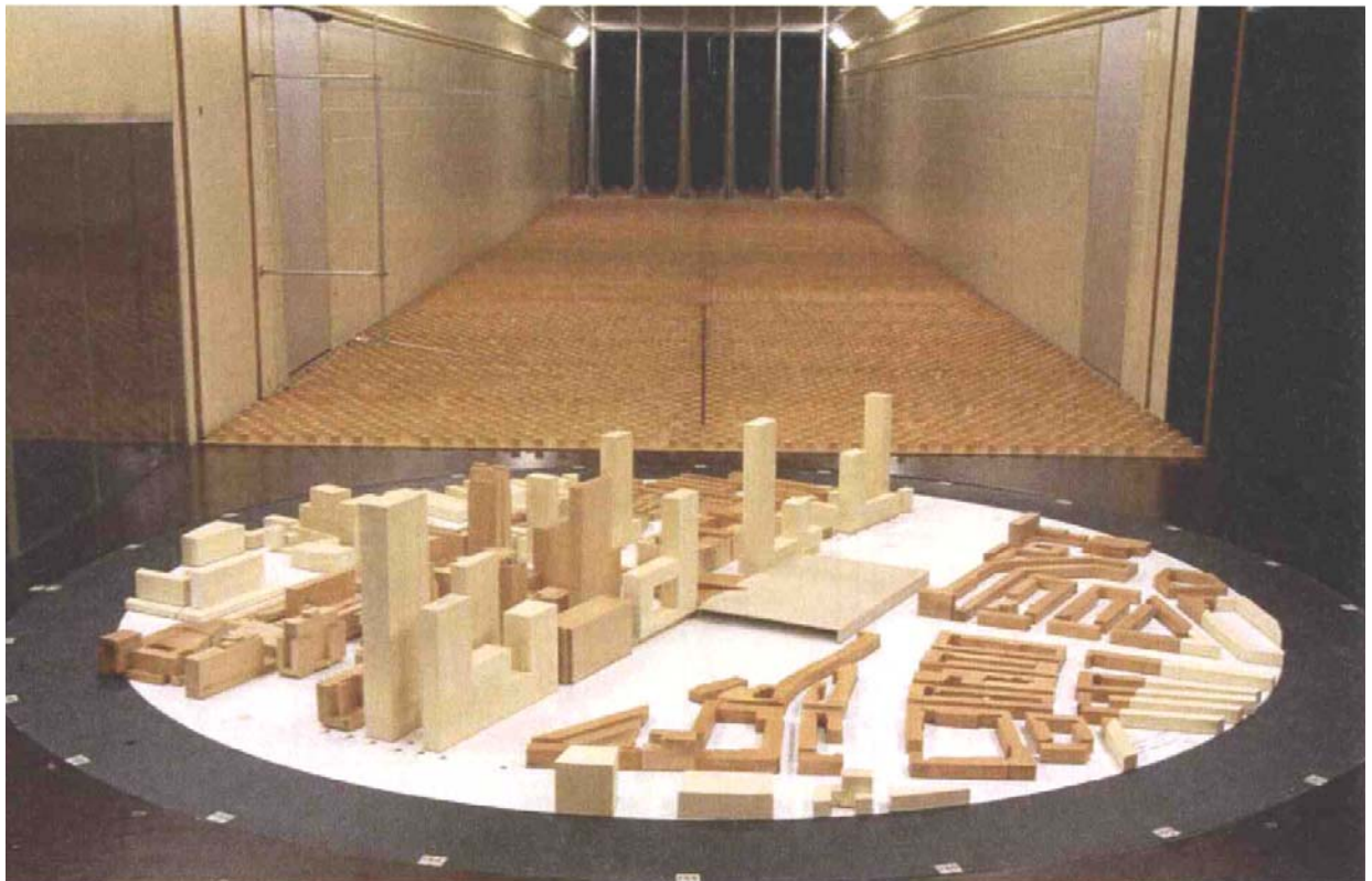
Figuur 11.1 Het model van de Voorgenomen activiteit in de windtunnel van TNO Apeldoorn
