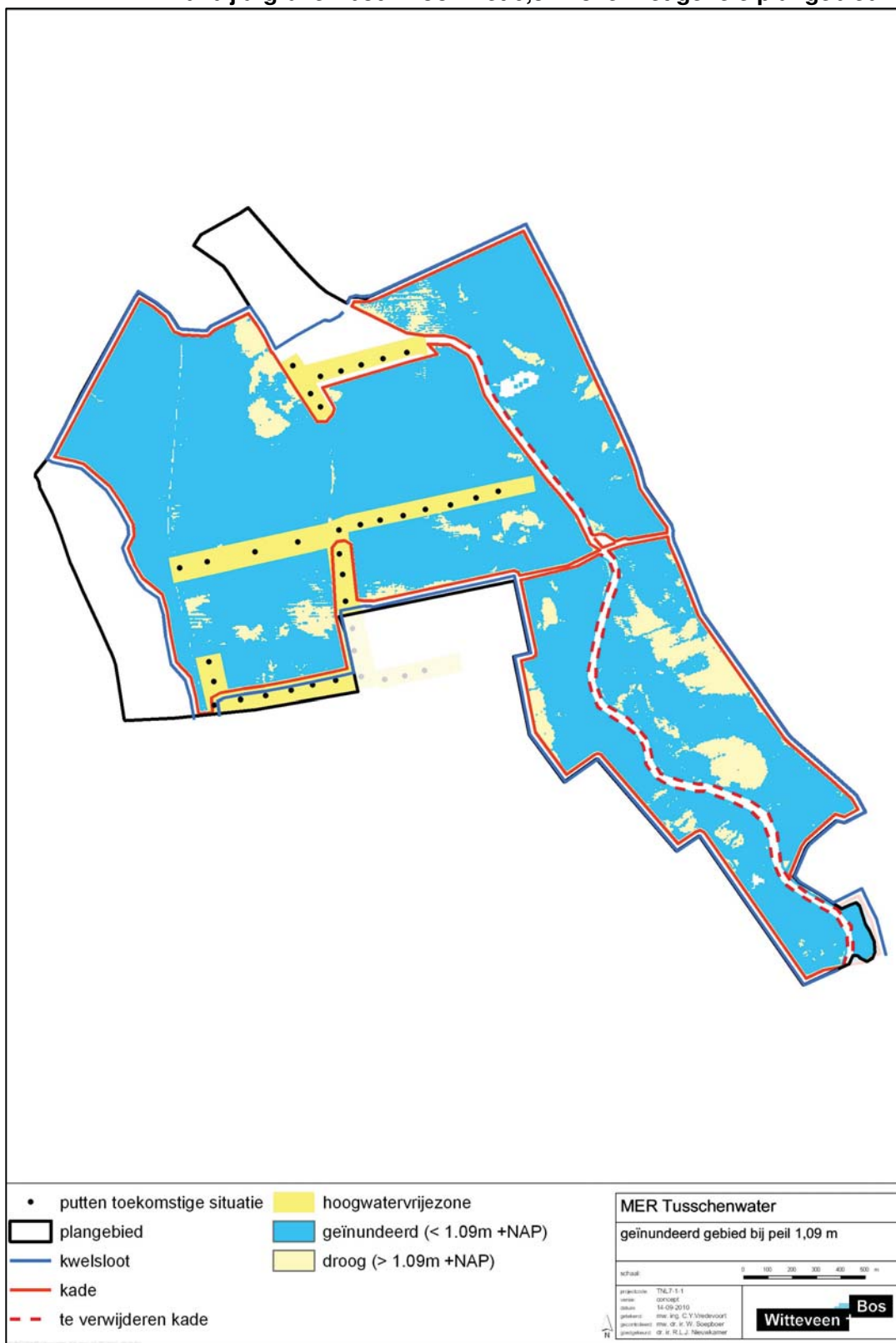
afbeelding 5.4. Inundatievlakte bij peil NAP + 1,09 m (piekafvoer) a. bij huidig maaiveld b. bij afgraven bouwvoor met 0,3 m over het gehele plangebied
