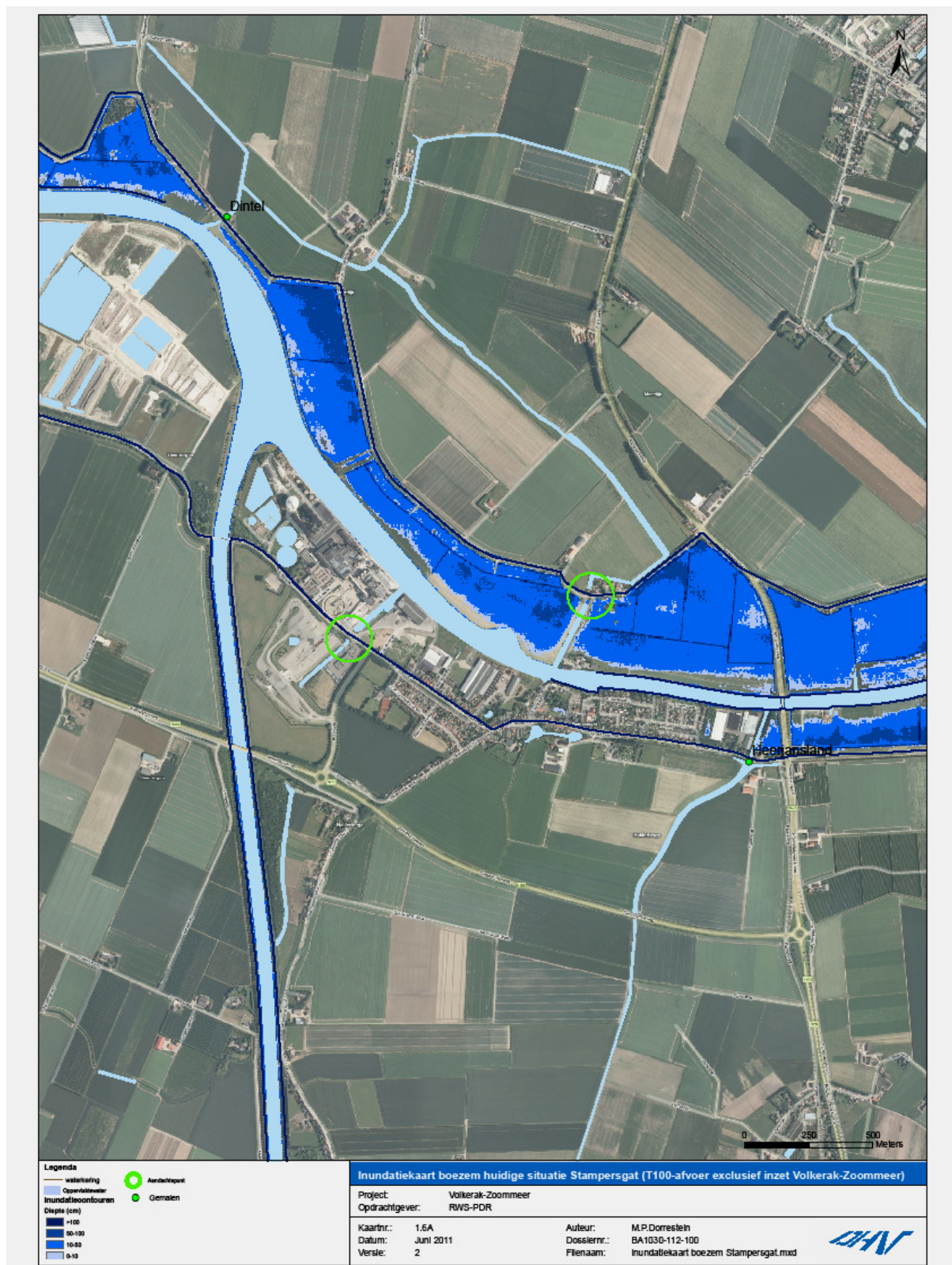
Figuur 4. 5 Voorbeeld van de inundatie die in de huidige situatie op kan treden, in de boezemgeende van het Mark-Vlietsysteem (omgeving Stampersgat)
