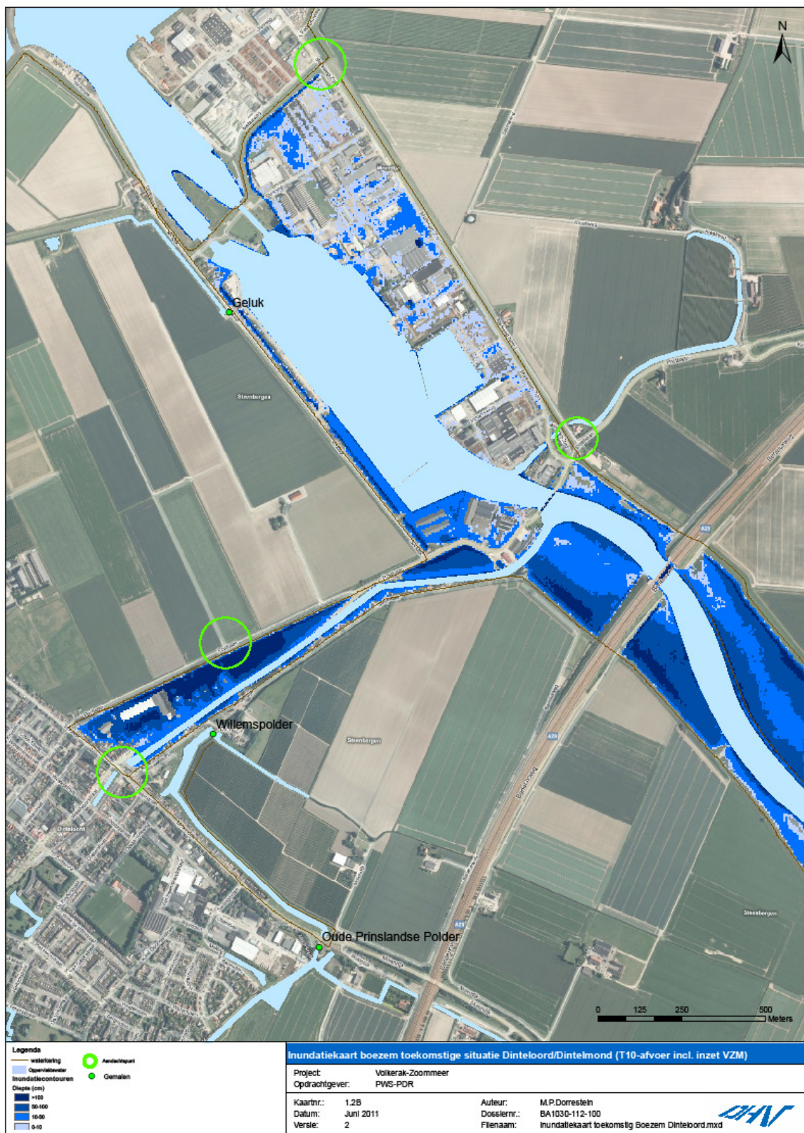
Figuur 4. 4 Voorbeeld van de inundatie die tijdens de waterberging op kan treden in de boezemgebieden van het Mark-Vlietsysteem (omgeving Dinteloord)
