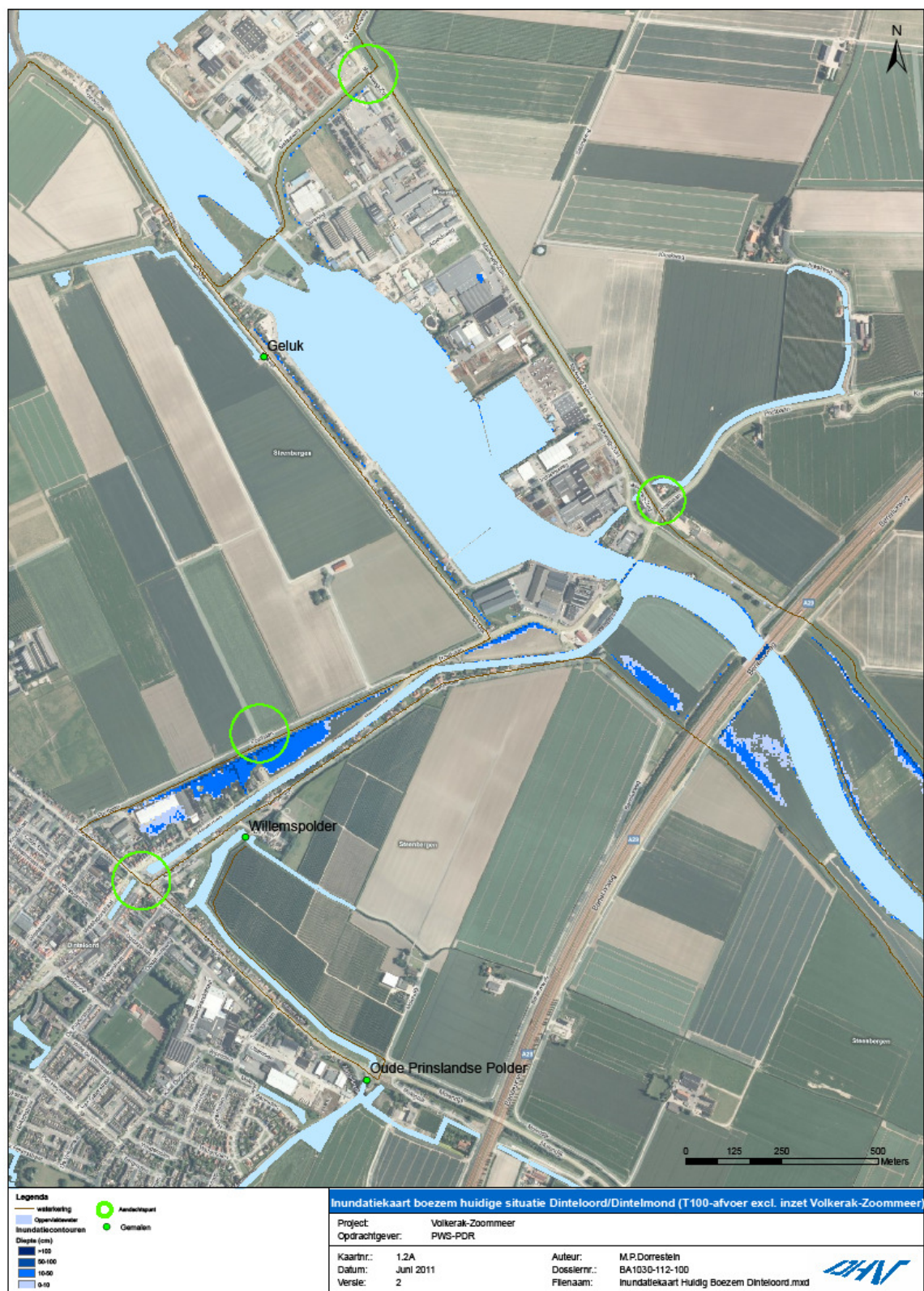
Figuur 4. 6 Voorbeeld van de inundatie die in de huidige situatie op kan treden, in de boezemgebieden van het Mark-Vlietsysteem (omgeving Dinteloord)
