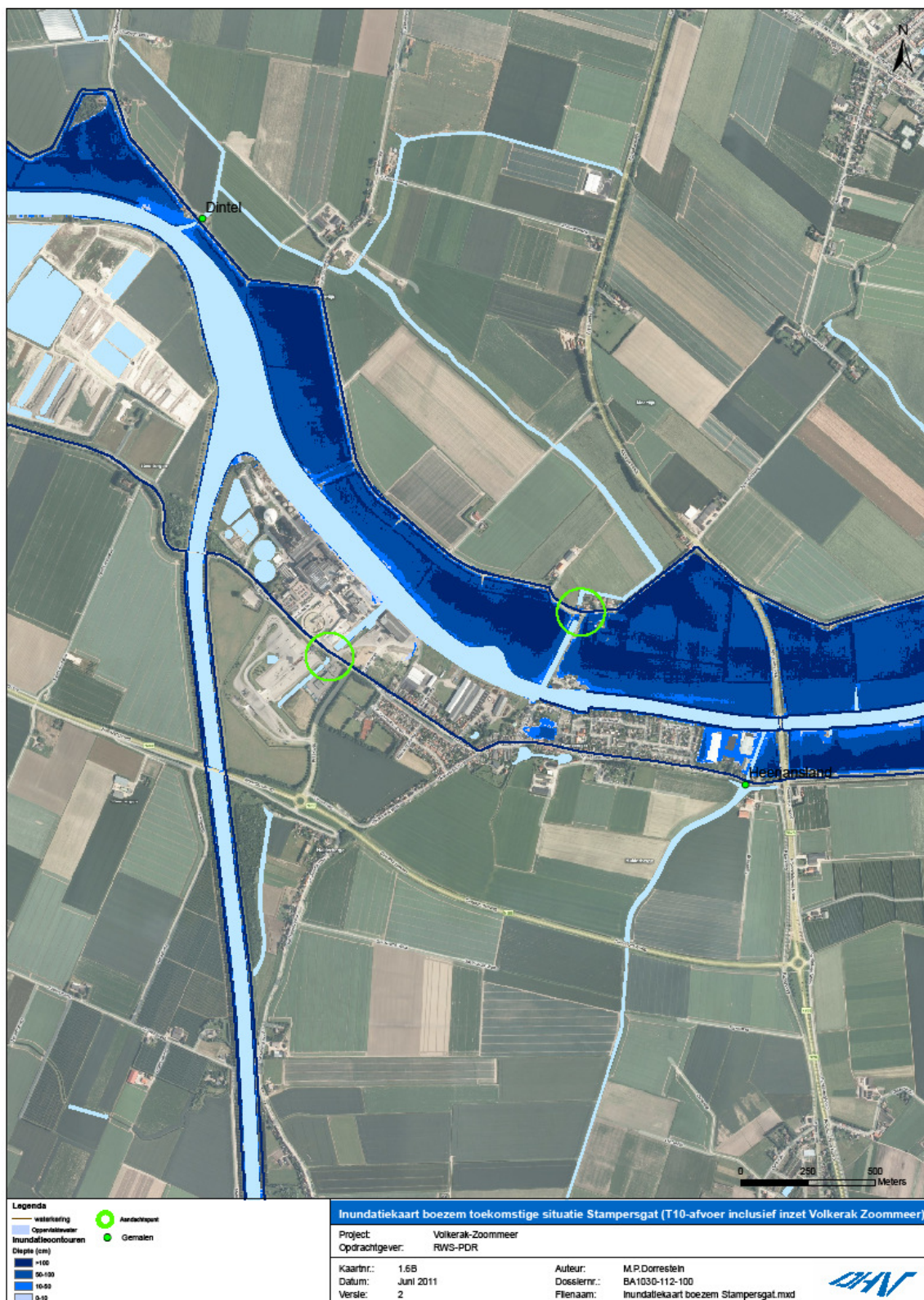
Figuur 4. 3 Voorbeeld van de inundatie die tijdens waterberging op kan treden in de boezemgebieden van het Mark-Vlietsysteem (omgeving Stampersgat)
