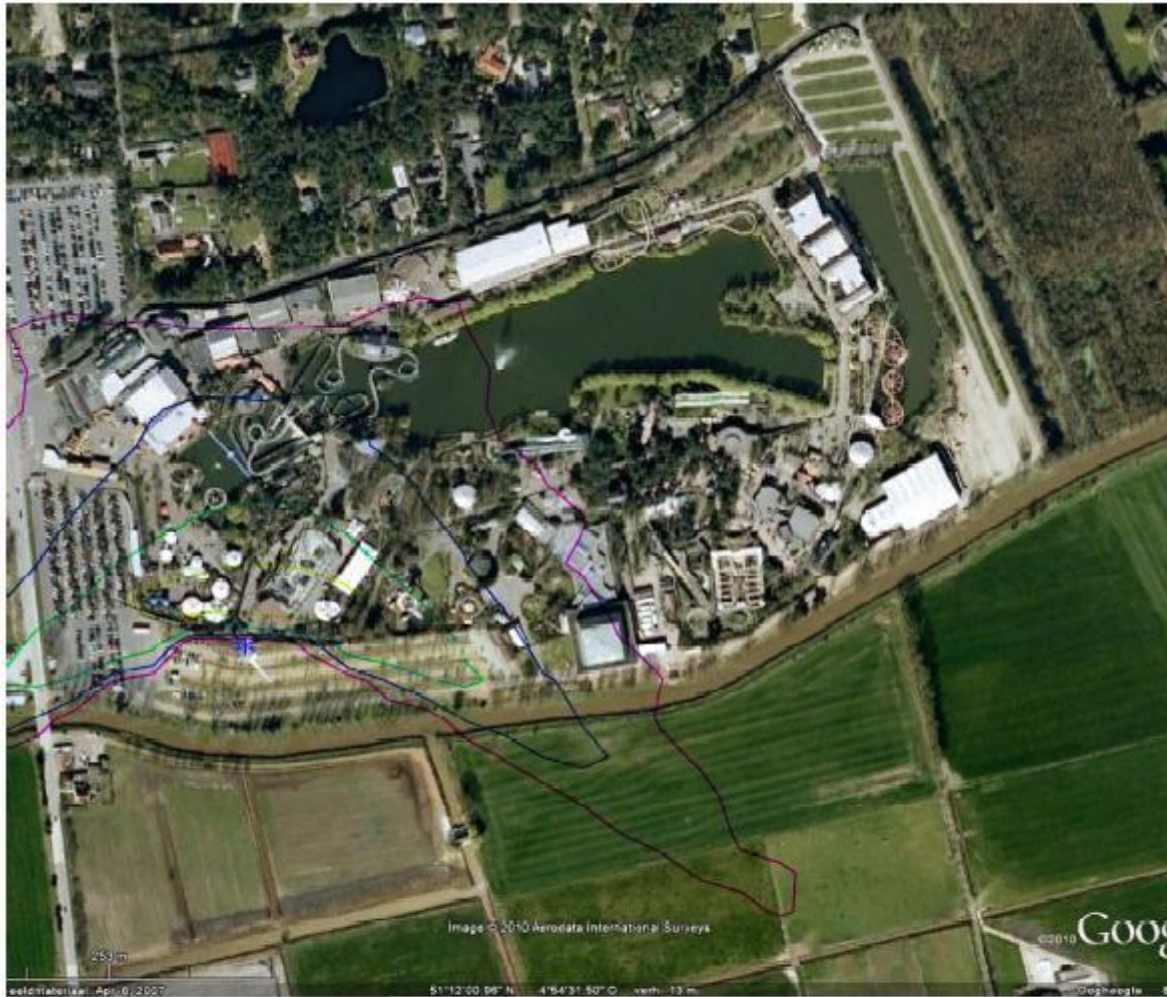
Figuur 6 Slagschaduwcontouren van een windturbine in Bobbejaanland
