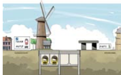
Stap 3: Treinverkeer is omgezet, tunnelbouw naast het oude spoor
