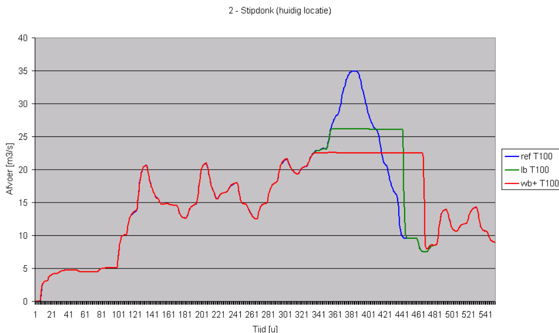
Figuur 6.2. Afvoer uit het waterbergingsgebied bij T=100: nulalternatief (blauw), basisalternatief (groen) en het basisalternatief plus (rood)
