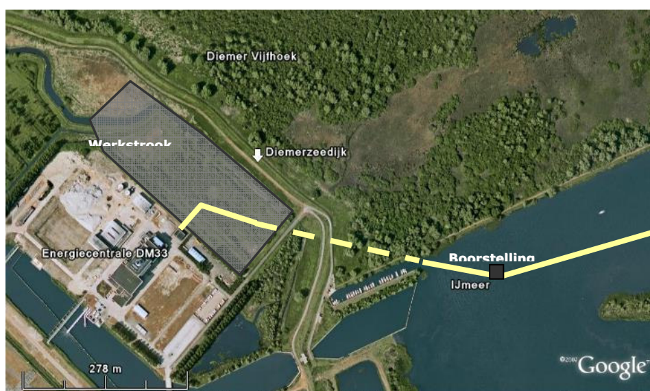
Figuur 4.9 Overzichtsfoto westelijk landdeel watertracé met leidingtracé, werkstrook en boorstelling.
