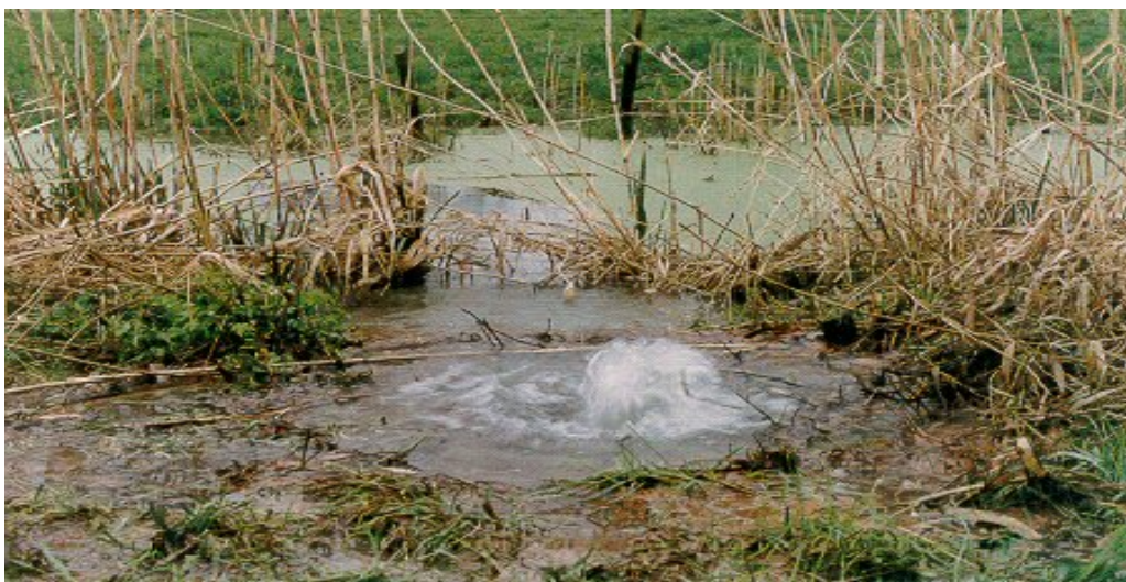
Figuur 2.1 Voorbeeld van mechanisme piping. Bron: http://www.delftgeosystems.nl/NL/page61.asp
