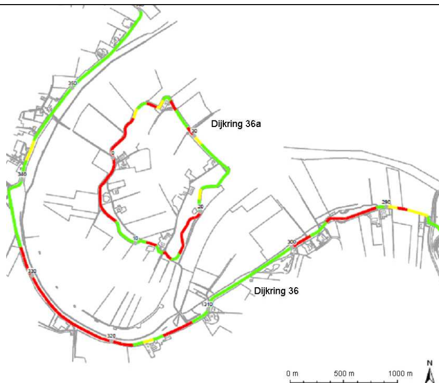
Figuur 1.1 Projectomgeving met resultaten van het pipingonderzoek van Arcadis uit 2006 [3] Rood is onvoldoende kwelweglengte, geel is onvoldoende bermhoogte
