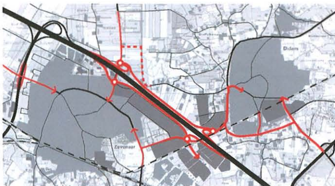
Varianten: één afslag, of parallelstructuur met twee halve afslagen
