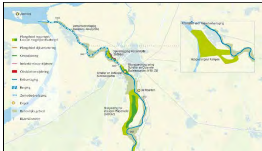
Figuur 2.1 Maatregel zomerbedverdieping Beneden-IJssel en planologische reservering bypass (bron: PKB deel 4 Ruimte voor de rivier, kaart 5)
