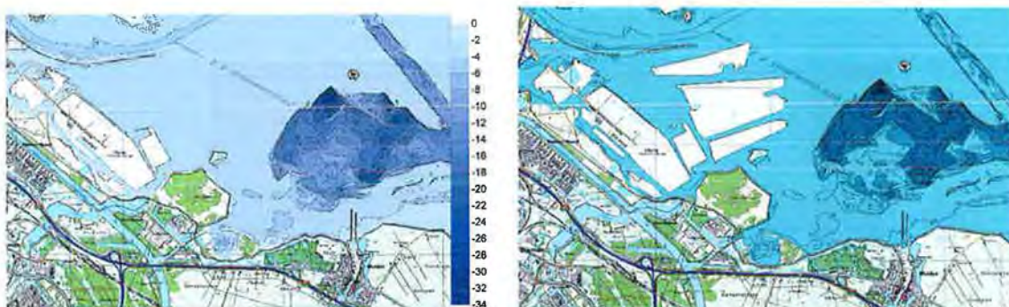
figuur 10 Gecompleteerde dieptekaart van het IJmeer rondom de Diemen - centrale. De donkerblauwe kleur staat voor een diepe bodemlocatie; de lichtblauwe kleur voor ondiepere delen (RWS-IJsselmeerdienst, 2006, kaart Kadaster 1:25.000 ( )). Links: de oorspronkelijke kaart aangevuld tot de oever, rechts: dezelfde kaart aangevuld met de geplande eilanden (fase-2).
