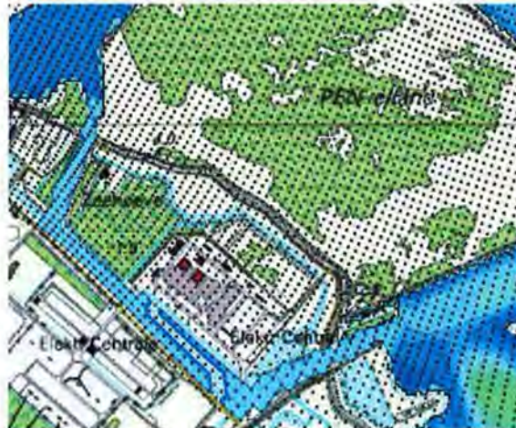
figuur 7 Rekenraster gebaseerd op een hoge resolutie bathymetrie in de buurt van de Diemen centrale. Op deze locatie is de resolutie ongeveer 10 x 10 m.
