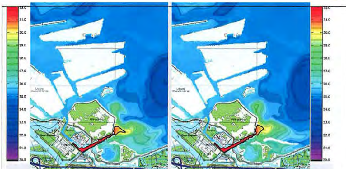
Figuur 8 Vergelijking van de berekende oppervlaktetemperaturen van scenario 5 (links) en scenario 6 (rechts), 12 augustus, 16:49. Schaal gefixeerd op 20 – 32°C (oorspronkelijke range scenario 5: 22-33°C, scenario 6: 22-33°C). Rode kleur houdt in: 32 °C en hoger. Isotherm op 30 °C
