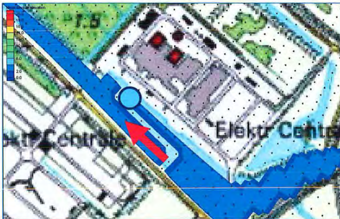
figuur 4 Modelrepresentatie van de inlaat en uitlaat. De lozing vindt plaats over de hele breedte van het uitlaatbassin (aangegeven met de rode pijl), de inname vindt plaats aan het einde van de inlaathaven (aangegeven met de blauwe cirkel).
