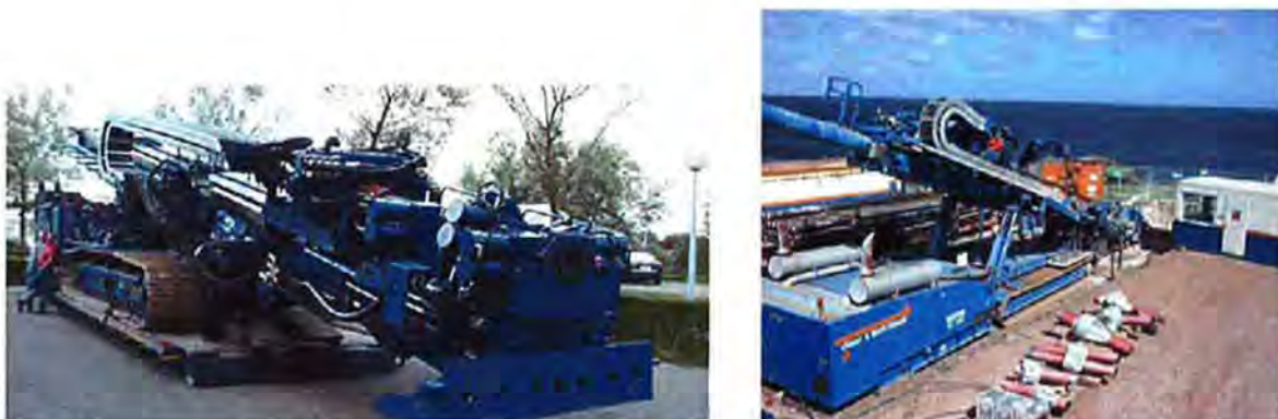
Figuur 3.16 Boormachine t.b.v. gestuurde boring (bron: VSMC)
