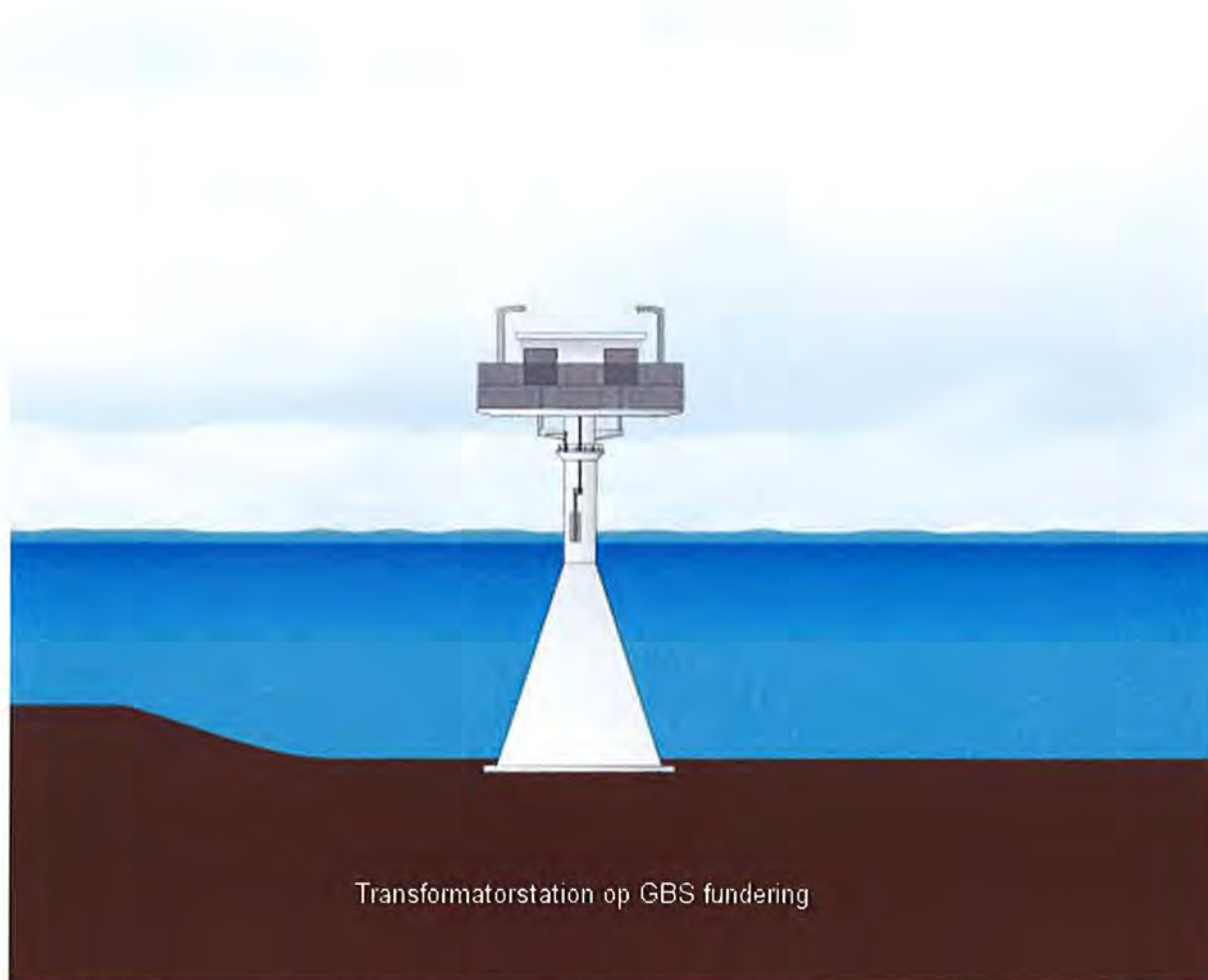
Figuur 2.13 Transformatorstation op GBS-fundering
