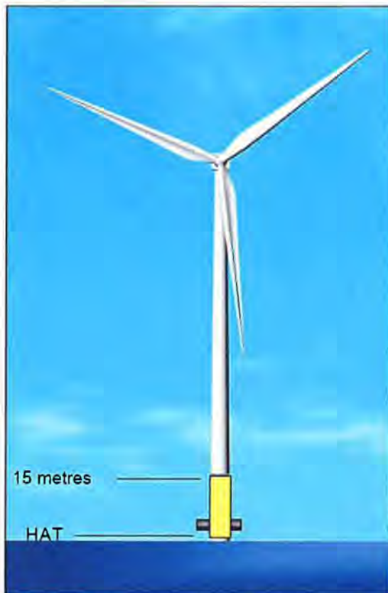
Figuur 5.2 De windturbine met gele markering van HAT tot 15 meter boven HAT (bron: IALA Recommendation O-117)
