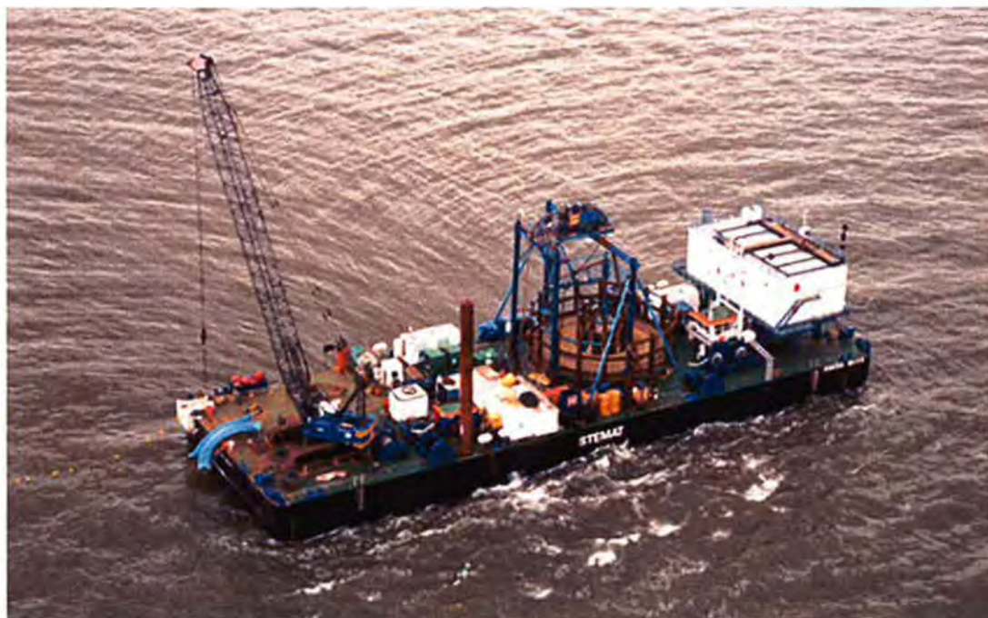
Figuur 3.10 Vaartuig voor het offshore leggen van kabels
