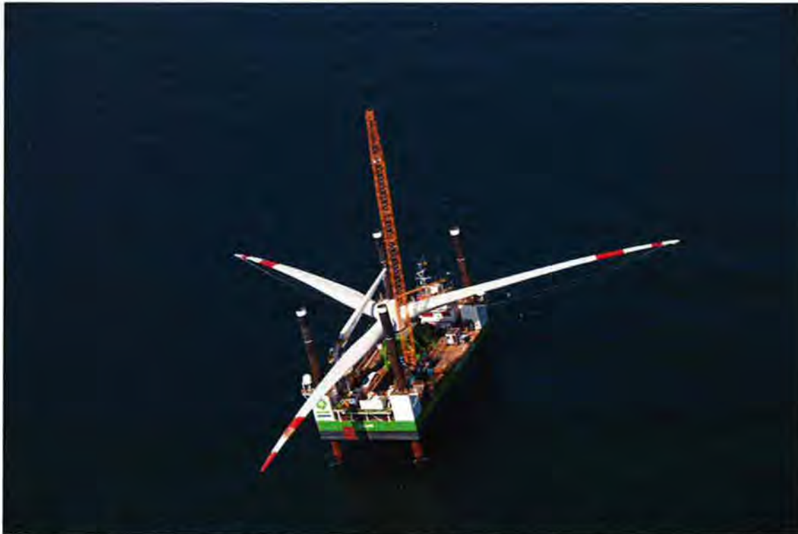
Figuur 3.5 Offshore transport van een REpower 5M rotor (Bron: Thornton Bank)
