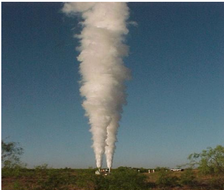
Figuur 22: Foto CO 2 uitstroming bij afblazen superkritische pijpleiding
