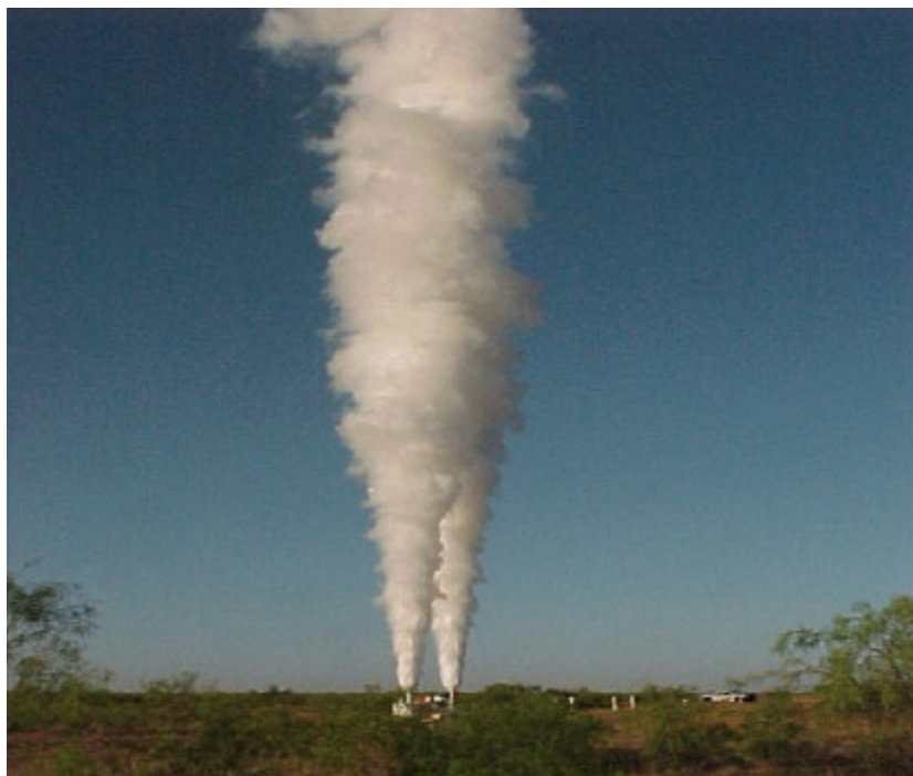
Foto: Verticale uitstroom van CO 2 uit een proefinstallatie.
