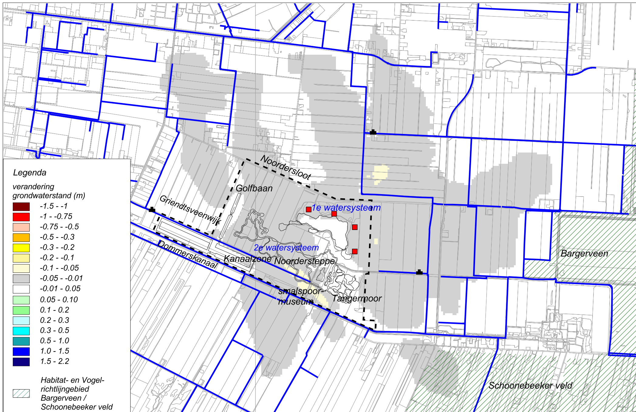
Figuur 7.5 Kaart met de berekende verandering in stijghoogte (tussen scenario 5 en ongestoord situatie) in het eerste watervoerend pakket bij aangepaste modelparameters
