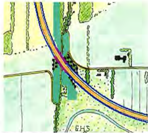
Figuur 6.30: Geleiding naar de faunapassage Balkweg. Groen=begrenzing beplanting, zwarte stippen=beplanting die beter niet kan worden aangelegd, paars= hoge reling, blauw=rasters.
