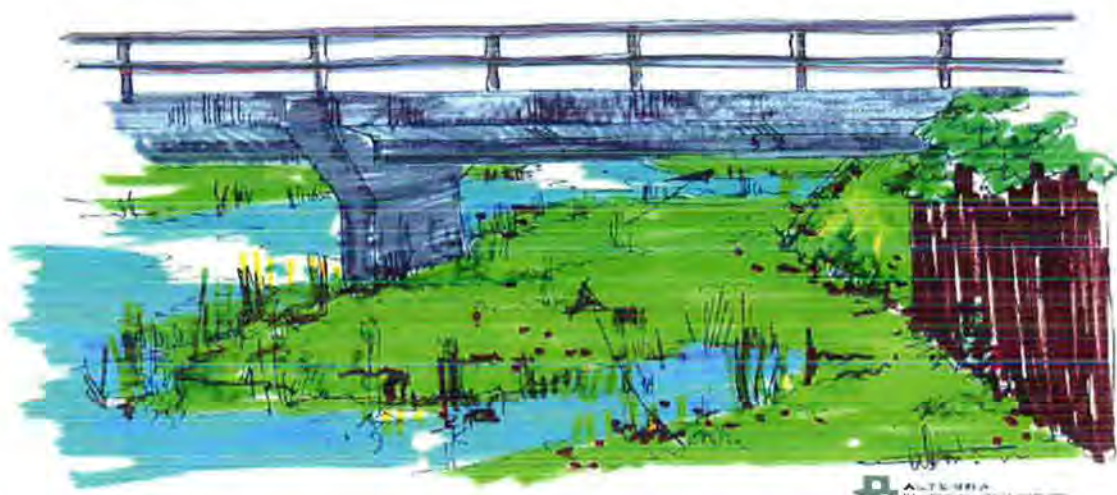
Figuur 6.13: een brug met natte faunapassage, bron: Opdam, 2001.
