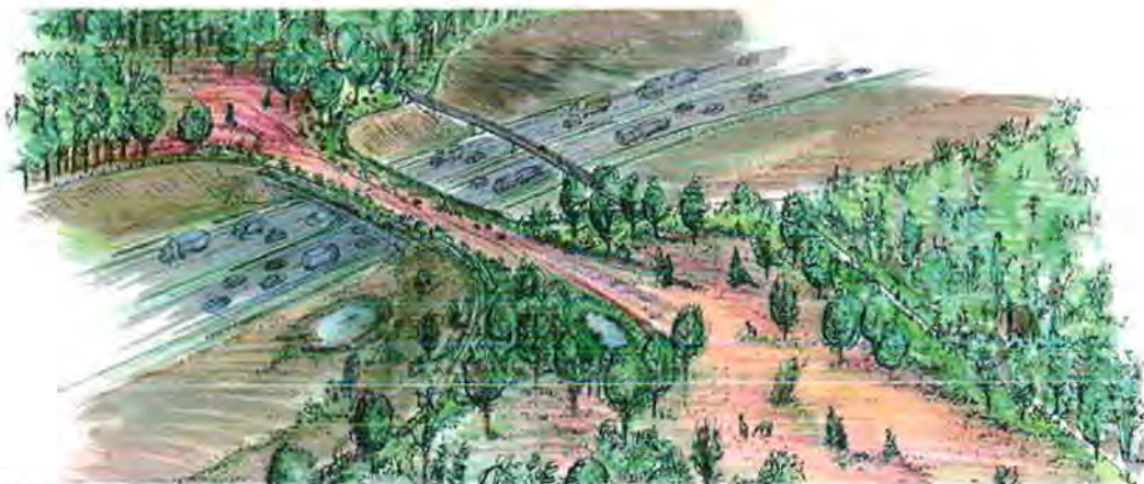
Figuur 6.48: Voorbeeld van de inrichting van een ecoduct dat goed is aangesloten op de omgeving.
