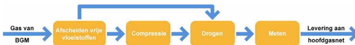
Figuur 4.5-4: Schematische weergave van de gasproductie op BKM
