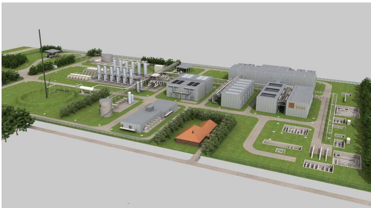
Figuur 4.5-2: Artist impression van de ligging en inrichting van de behandelings- en compressie-installaties volgens het voorkeursalternatief
