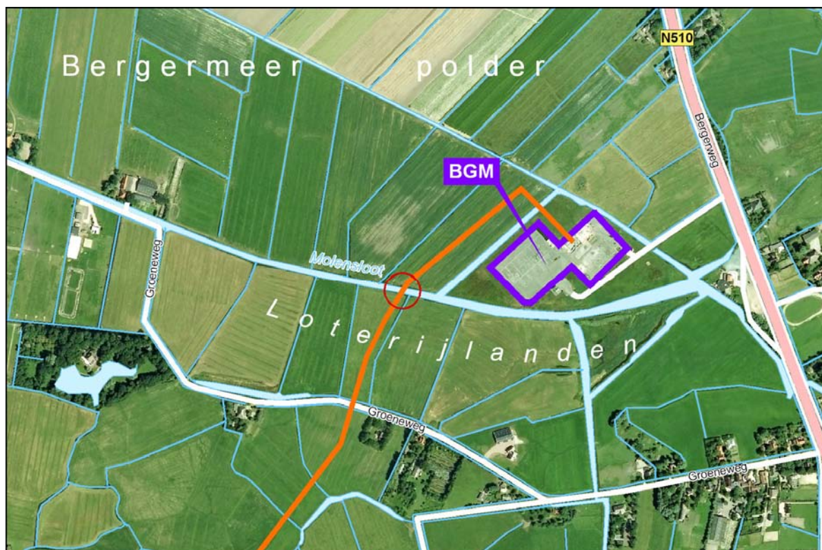
Figuur 4.6-5: Kaart met het tracé voor de gestuurde boringen onder de Loterijlanden, de Molensloot en de Groeneweg
