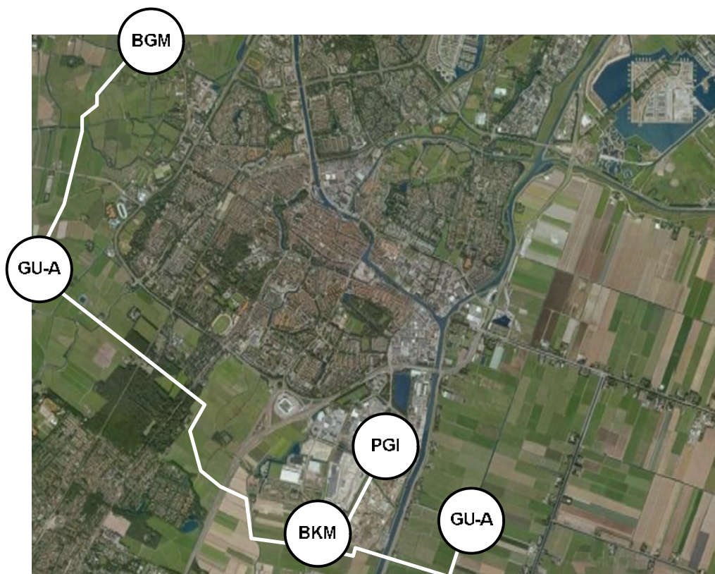
Figuur 1.1: Leidingtracé inclusief de aansluitpunten
