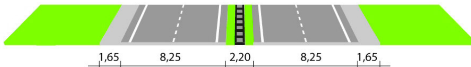
Afbeelding 3.7. Principe dwarsprofiel N 340 (2x2 rijstroken, brede bermen) tussen spoorverbinding Zwolle-Meppel en Ankummerdijk
