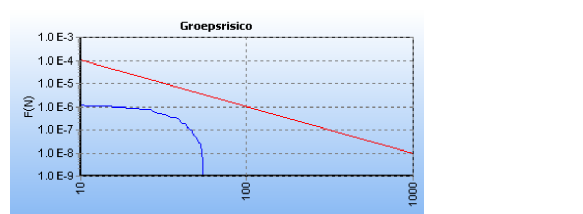
Figuur 12b: FN-curve worst-casesegment Z-553-01, situatie 'effectbeschrijving 2020'. Overschrijdingsfactor 0.05.
