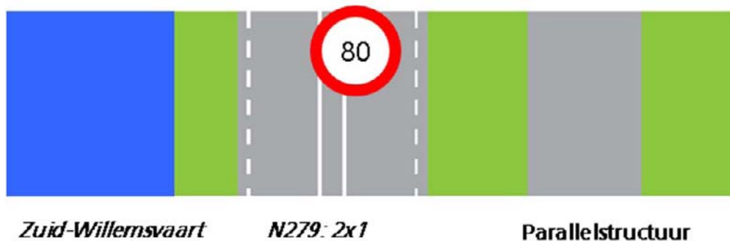
Figuur 3.6: Globaal dwarsprofiel huidige N279, tevens referentiesituatie
