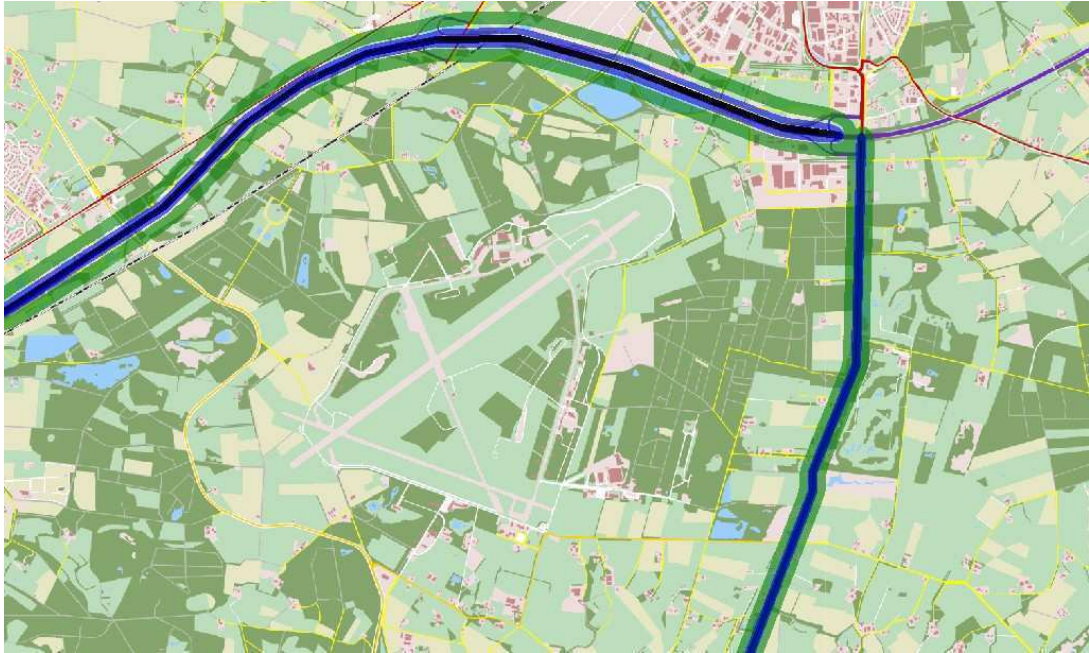
Figuur 3 PR als gevolg van VGS over de weg in de referentiesituatie, Structuurvisie A en in Structuurvisie B. Groen: 10^{-8} /jaar, Blauw: 10^{-7} /jaar
