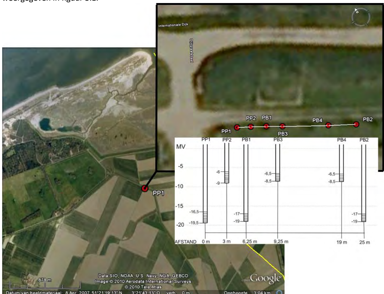
Figuur 3.1 Overzicht van locaties van de pompputten en observatieputten van de dubbele pompproef ter hoogte van de kruising Internationale Dijk en Dijkgraafstraat.
