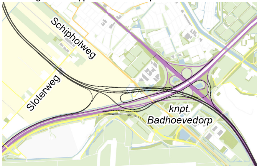
Afbeelding 2.7. Knooppunt Badhoevedorp - klaverturbine
