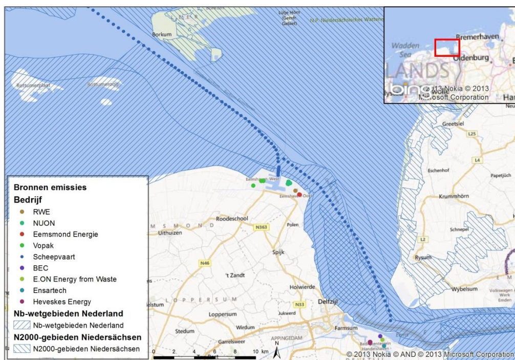
Afbeelding 4: Emissiepunten stikstof. De scheepvaart is tot 60 km uit de kust gemodelleerd (niet geheel in de afbeelding weergegeven)
