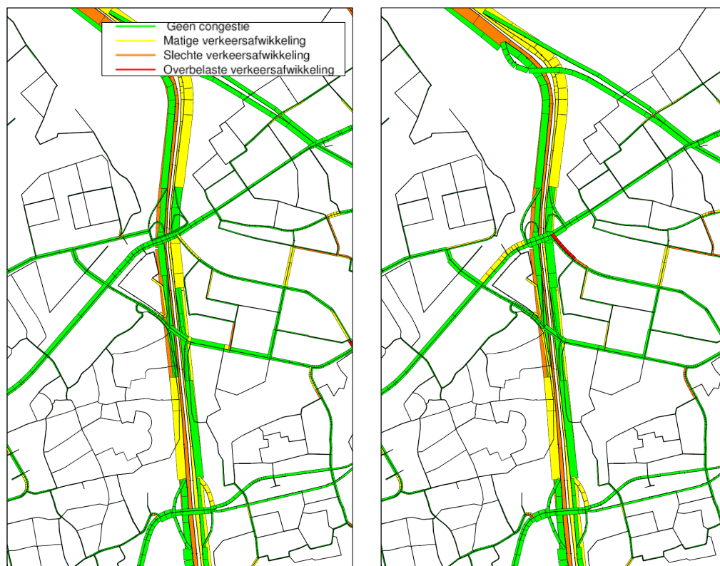
Figuur 3.4 IC-verhouding 2020 Avondspits met kilometerprijs, Voorkeursalternatief en (links) en alternatief Meerenakkerweg (rechts)
