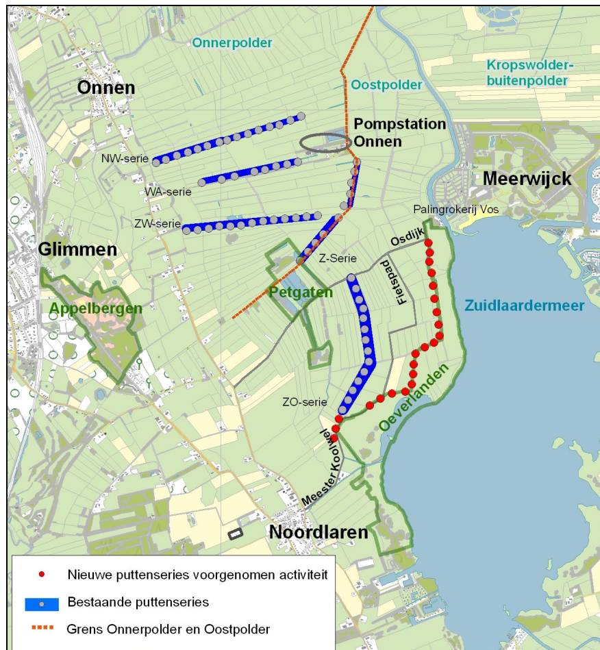
Afbeelding 1.2 Drinkwaterwinning Onnen met pompstation, puttenseries en voorgenomen activiteit *
