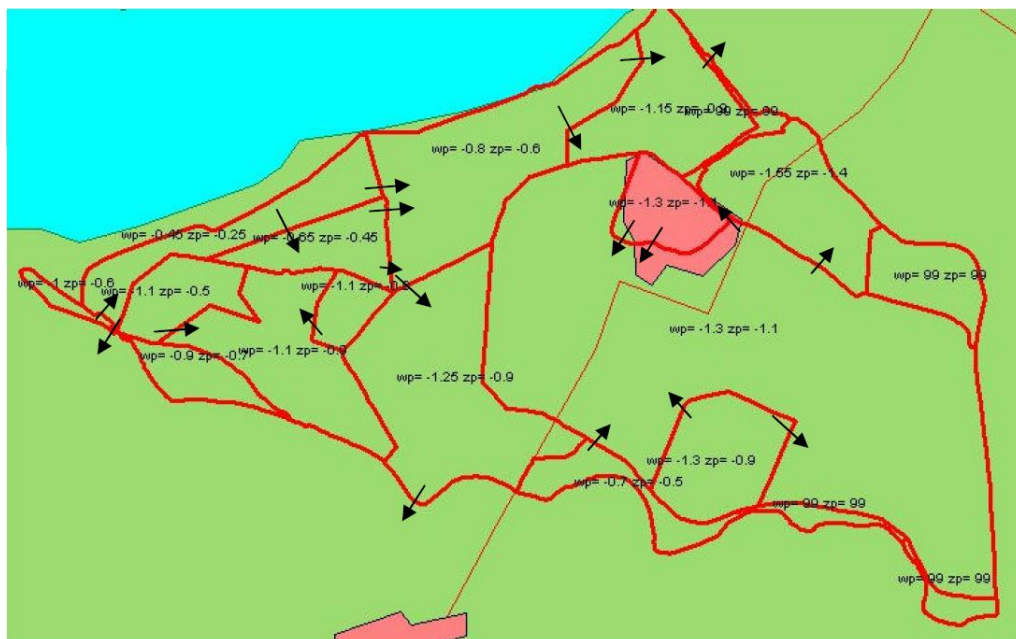
Figuur 8.6: Schematische weergave van waterafvoer routes van het polderwater (bron: TNO, 2007)
