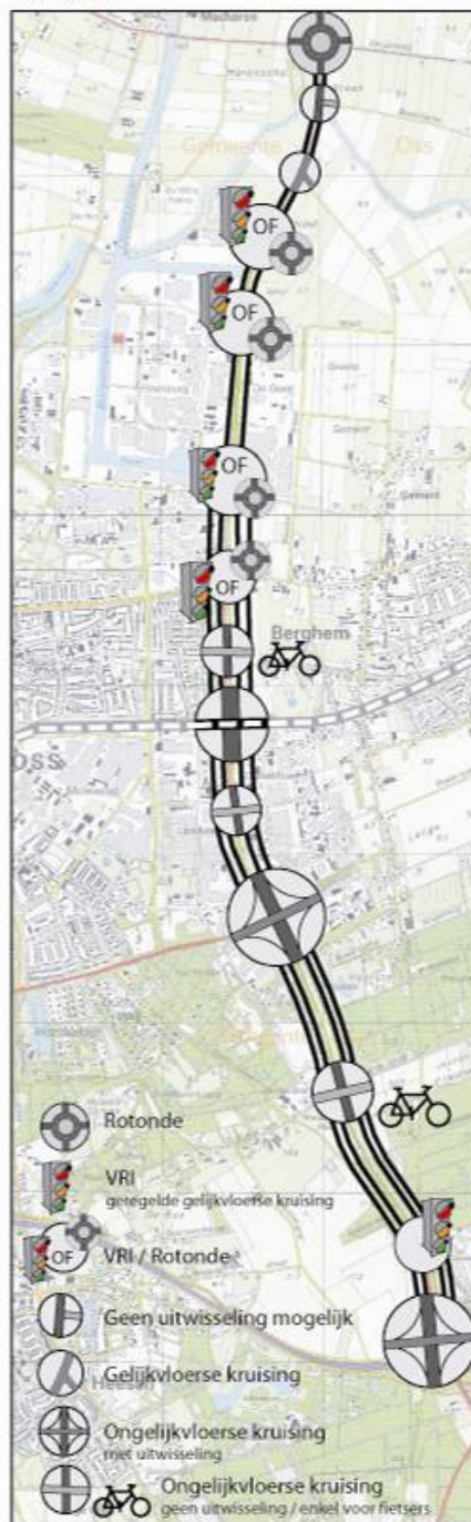
Figuur 0.3 en 0.4: schematische weergave variant 1 (nulplus) en 2 (2x2 ongelijkvloers, minimale uitwisseling)
