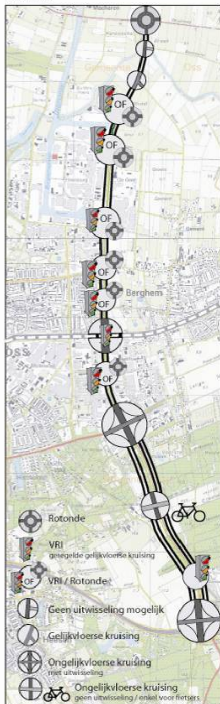
Figuur 0.3 en 0.4: schematische weergave variant 1 (nulplus) en 2 (2x2 ongelijkvloers, minimale uitwisseling)
