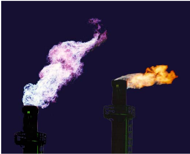
Figuur 5. Twee opnamen van de vlam op de fakkel tijdens verschillende bedrijfscondities. (De diameter van de fakkelbrander is 5 m). Links: opstarten van een vergasser en bij plotselinge trip van een gasturbine; blauwige vlam met een lengte tot > 30m. Rechts: verbranden van zwavelhoudend gas tijdens storingen in de ontzwavelingsinstallatie; gele vlam met lengten tot > 15 m.
