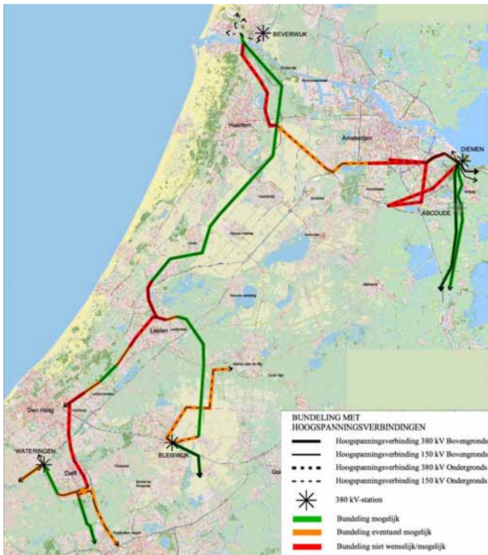
Figuur 4.2-1: Bundeling met hoogspanningsverbindingen
