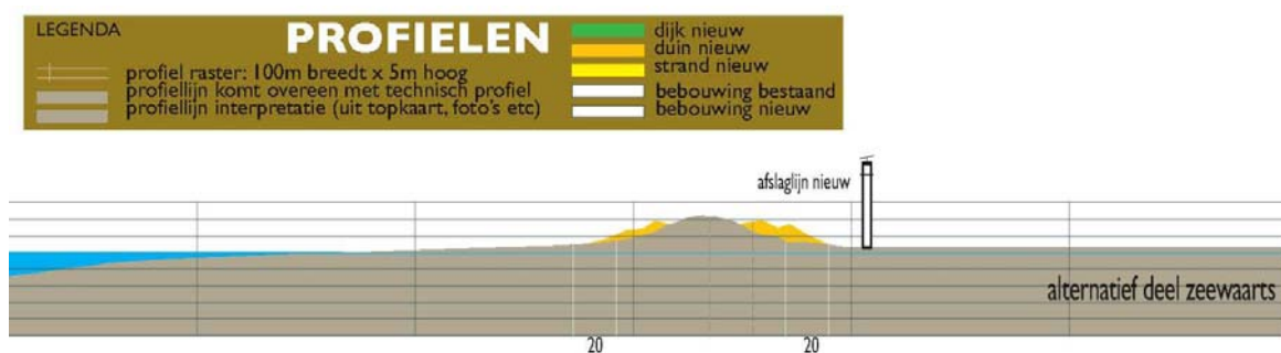
Figuur 0-5 Dwarsprofielen voorkeursalternatief Deels Zeewaarts voor Herdijkte Zwarte Polder
