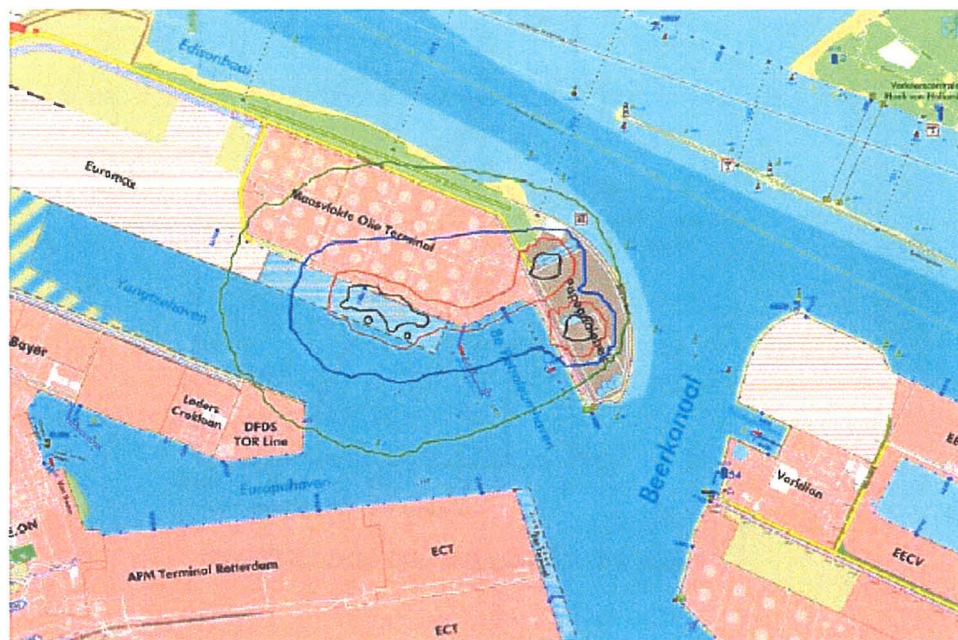
Figuur 3.2: Plaatsgebonden risico LNG-terminal (totaal)
