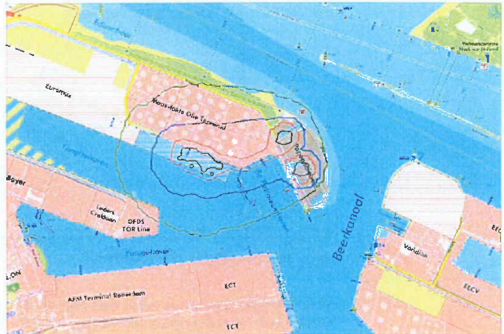
Figuur 7.17: Plaatsgebonden risico LNG-terminal (totaal).
