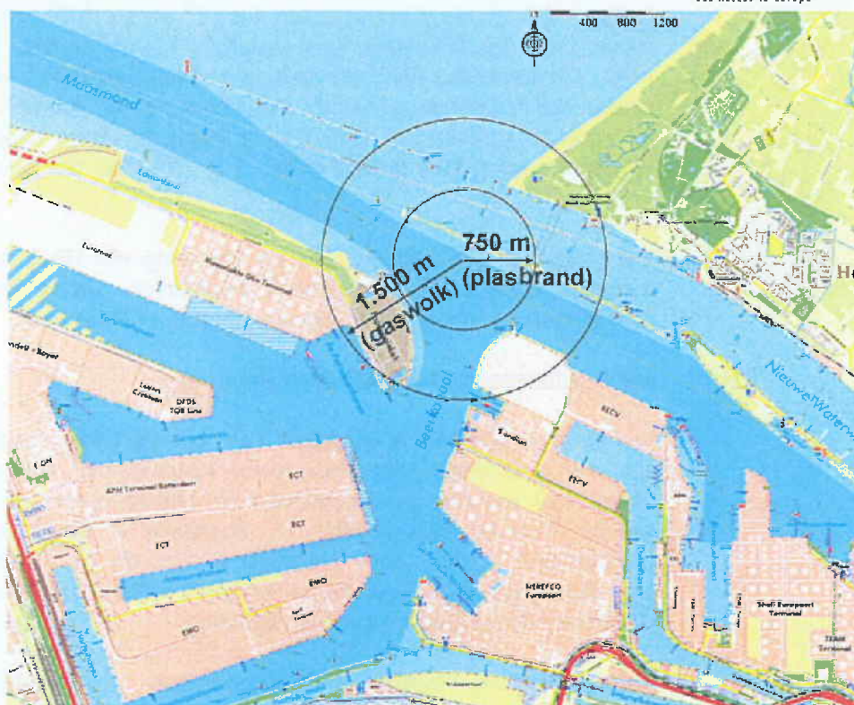
Figuur 7.8: Effectafstand van het MNCA-scenario in het kader van nautische veiligheid (gatgrootte LNG-schip: 1,5 m diameter).
