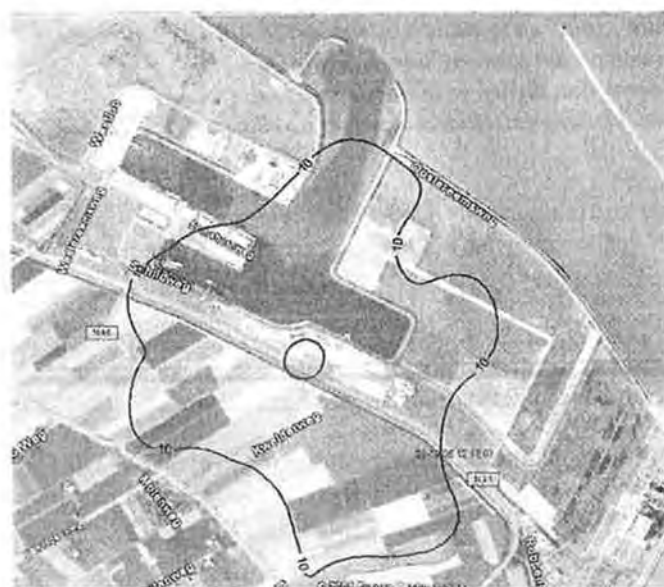
Figuur 2 Geurimmissie ingeval van nul-alternatief als 99,99-percentielwaarde (in g.e./m 3 ).
