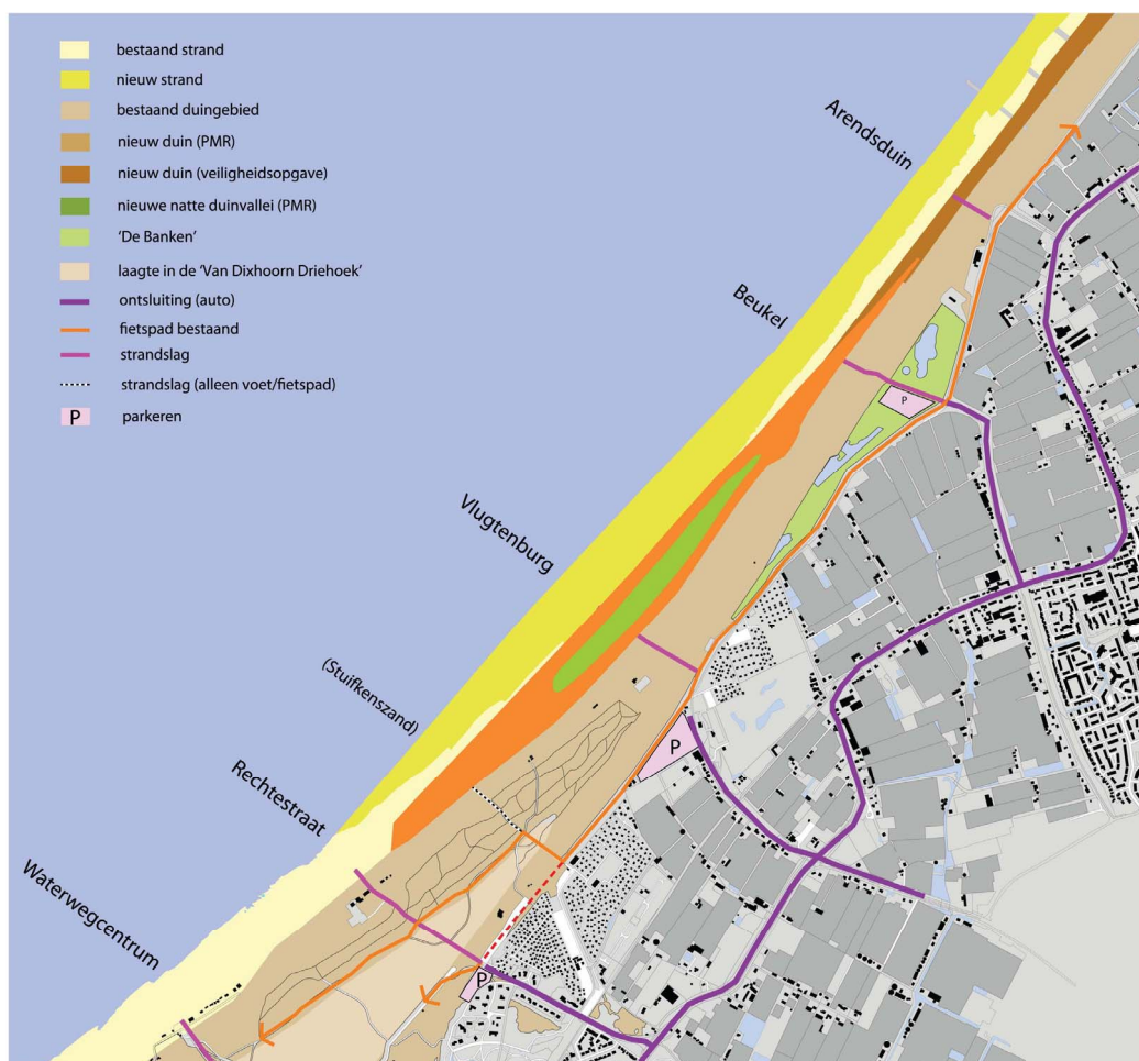
Figuur 5-2: Basisontwerp duincompensatie PMR
