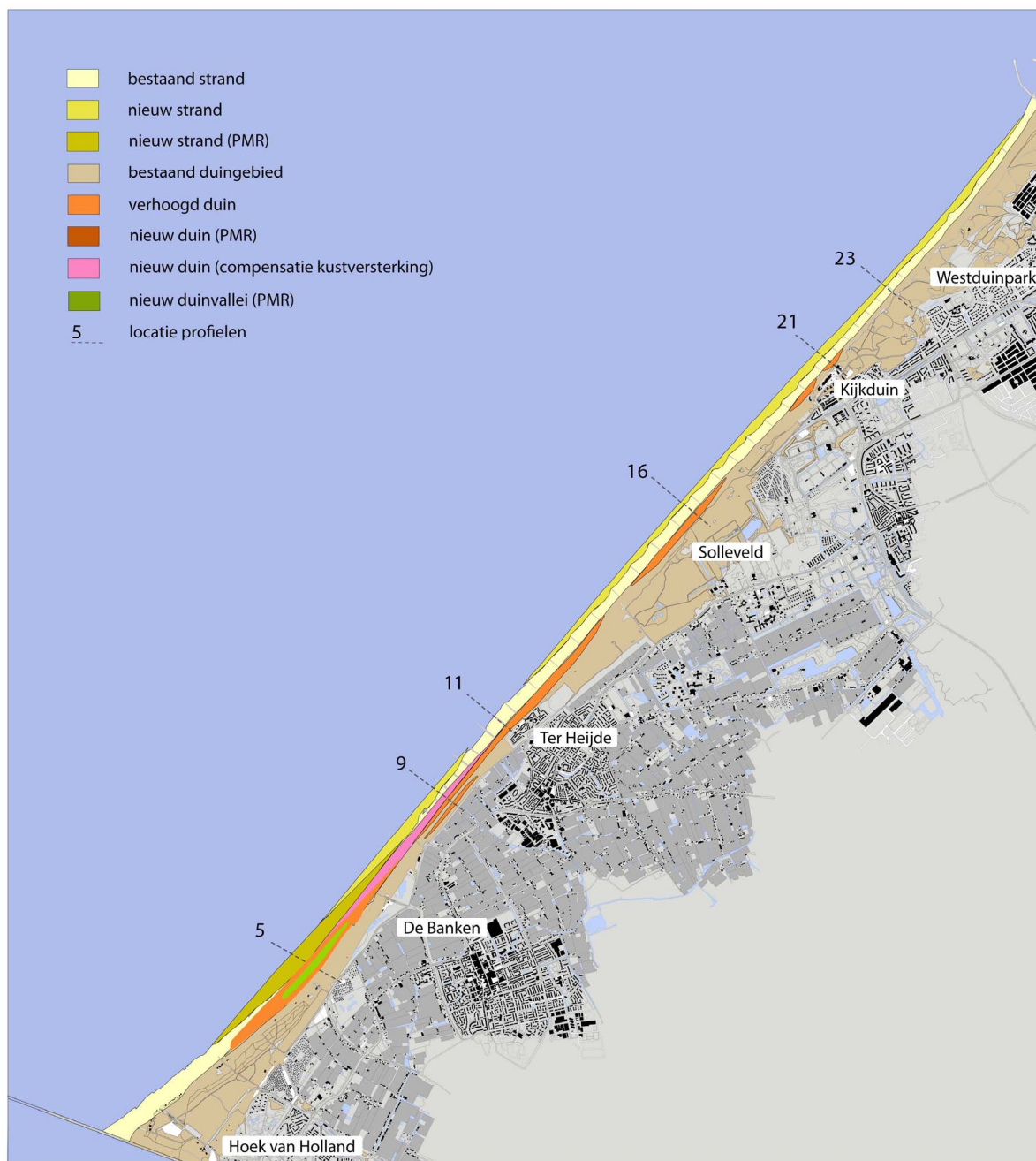
Figuur 5-3: Alternatief Verhoogde duinen (variant hard en zacht zijn vergelijkbaar)
