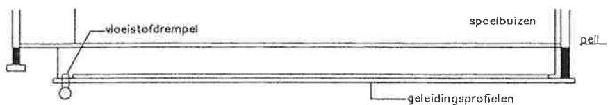
verdringings spoelsysteem doorsnede B-B
